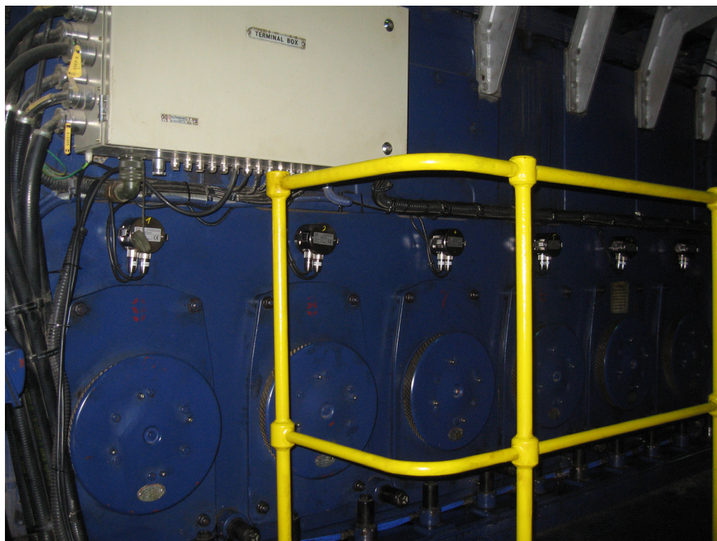
Fig. 5.12 Sensor de sistema SiCOMS® instalado en un motor de 4 tiempos
